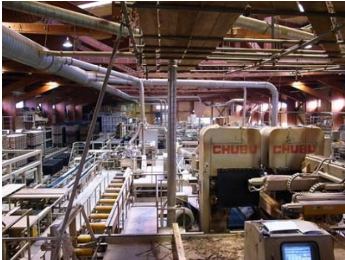
右に見えるのがツインソーです 2面カット出来るので効率がよいです
